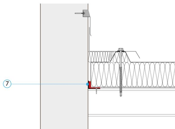
7 Joint d'étanchéité en polyuréthane ou mousse imprégnée bénéficiant du label SNJF ou conforme à la norme NF P30-305
