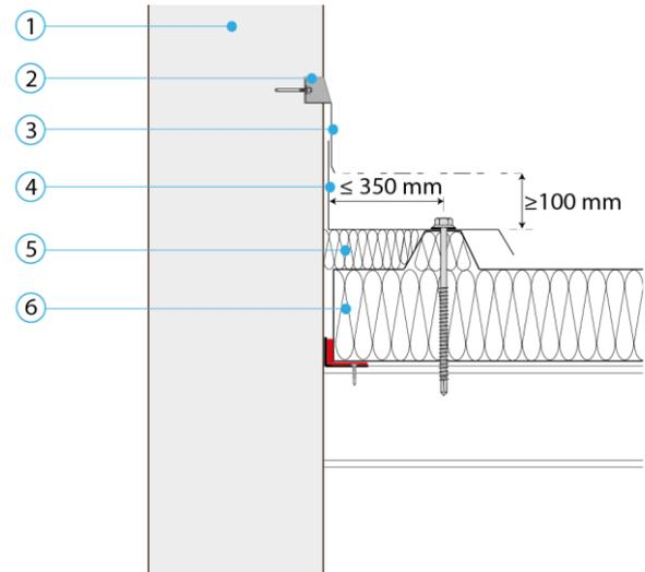
**Etanchéité avec joints**
