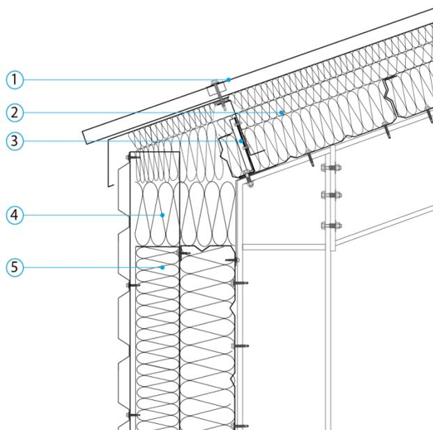
**Etanchéité à l'air avec Pare-air/pare-vapeur**
