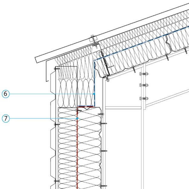
**Etanchéité à l'air avec Joints**
