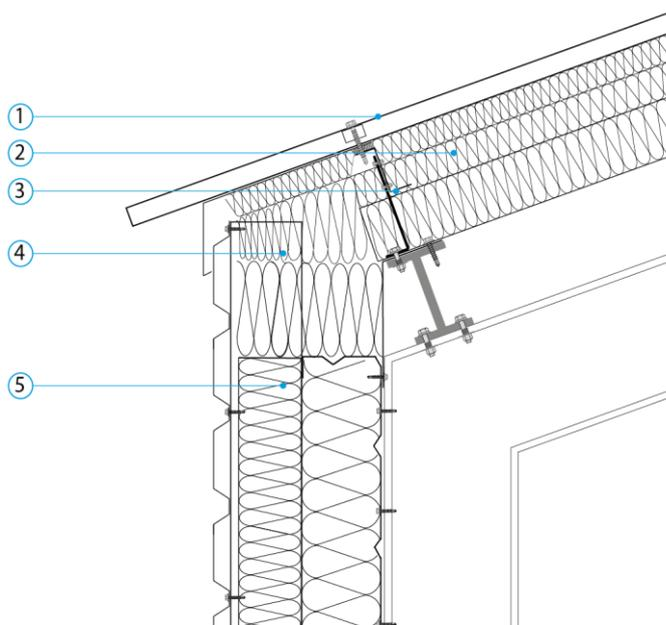
**Etanchéité à l'air avec Pare-air/pare-vapeur**
