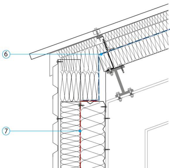
**Etanchéité à l'air avec Joints**
