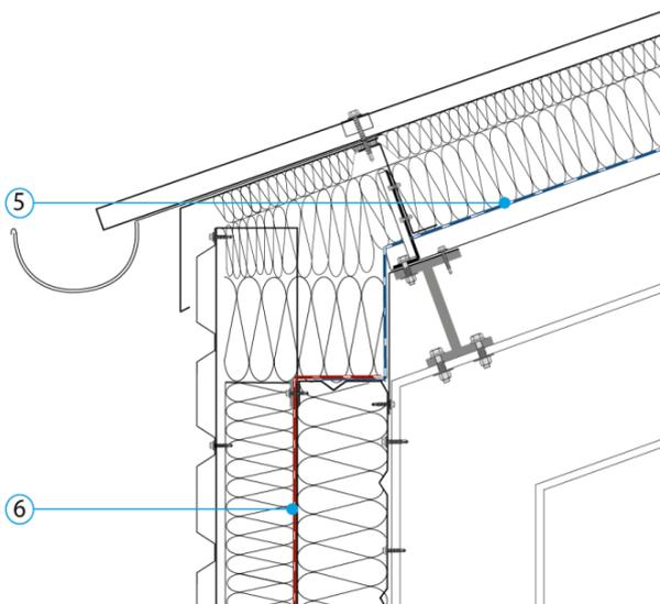
**Etanchéité à l'air avec Joints**
