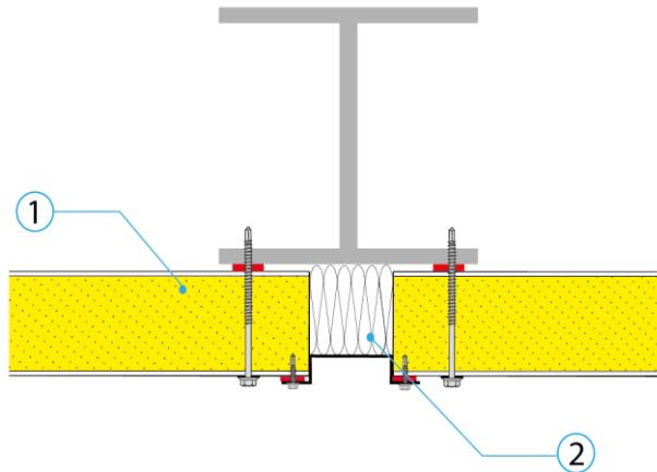
**Etanchéité à l'air avec Joints**
