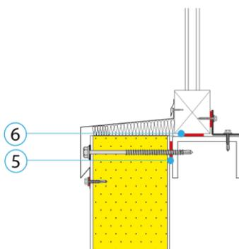
5 Joint d'étanchéité en polyuréthane ou mousse imprégnée bénéficiant du label SNJF ou conforme à la norme NF P30-305
