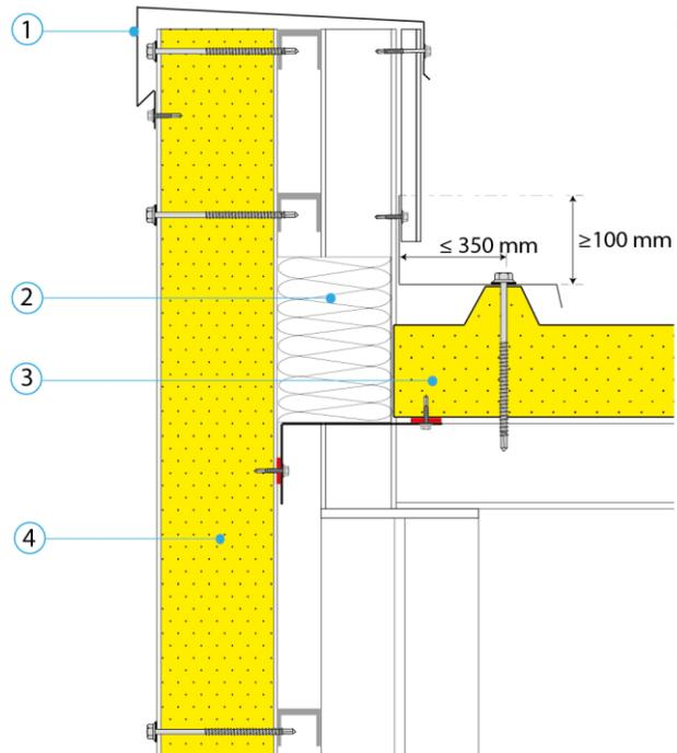
**Etanchéité à l'air avec Joints**
