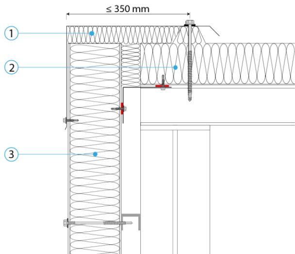
**Etanchéité à l'air avec Joints**
