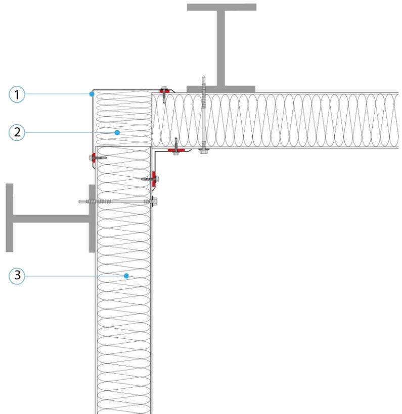
**Etanchéité à l'air avec Joints**
