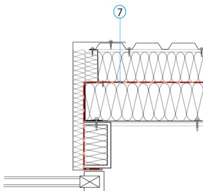
**Etanchéité à l'air avec Joints**
