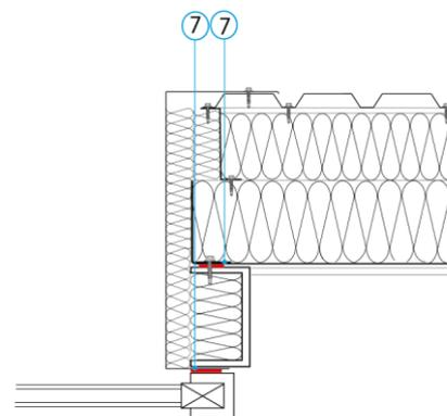
7 Membrane d'étanchéité à l'air de type HPV (Haute Perméabilité à la vapeur ;  $s_d < 0.1$  m)
