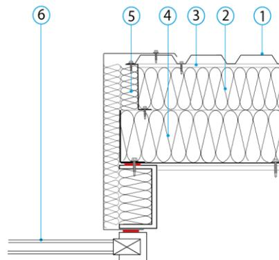
**Etanchéité à l'air avec Pare-air**
